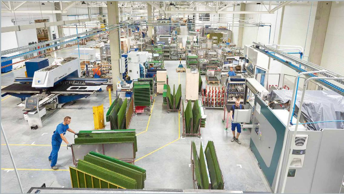
Stalgast verfügt über einen eigenen Produktionsstandort mit hochmodernen Anlagen. Um Edelstahlbleche vor Kratzern zu schützen, wird Kunststrasen eingesetzt und gänzlich – zum Wohle der Umwelt – auf Folien verzichtet
