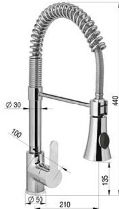
benötigte Lochbohrung  $\varnothing = 33\text{-}35$  mm
