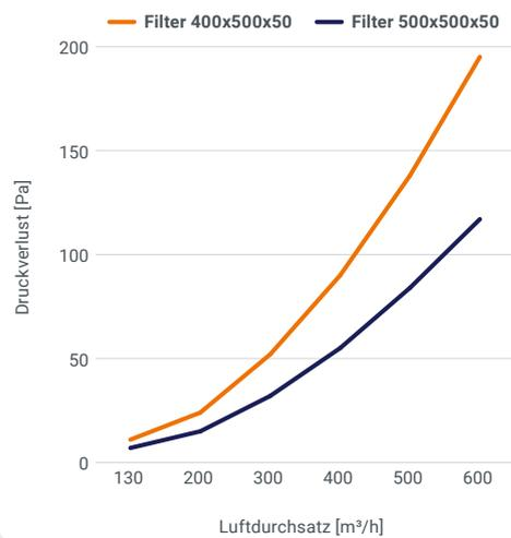
Alle LC2-Filter wurden im Labor der DMT GmbH & Co. KG nach DIN 18869-5 geprüft und zugelassen.
