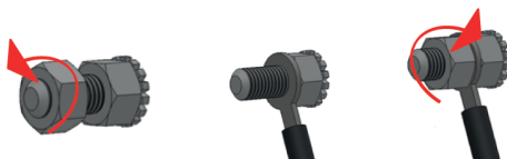
Rys. 3. Podłączenie urządzenia do instalacji wyrównującej potencjały elektryczne.
