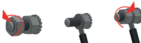
Bild 3. Der Anschluss des Gerätes an die Einrichtung zum Potentialausgleich
