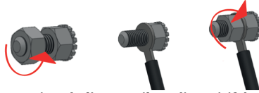
Figure 7. Connexion de l'appareil au dispositif équipotentiel.
