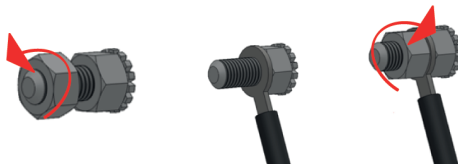
Obrázek č. 5. Připojení přístroje k zařízení pro vyrovnávání potenciálu.
