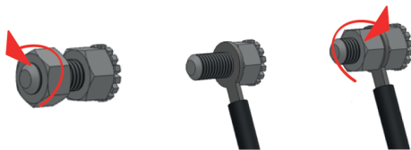
Obrázok 5. Pripojenie zariadenia do inštalácie na vyrovnávanie elektrických potenciálov.
