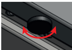
Figura 4. Nivelación del dispositivo
