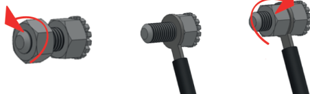
Fig. 5. Raccordement de l'appareil à une installation équipotentielle.
