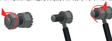
Rys. 5. Podłączenie urządzenia do instalacji wyrównującej potencjały elektryczne.
