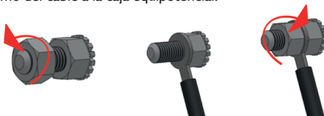
Figura 5. Conexión del equipo a una instalación equipotencial.
