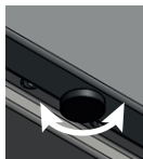
Bild 4. Ausnivellieren des Gerätes
