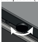
Figura 4. Nivelación del dispositivo
