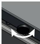
Rysunek 4. Poziomowanie urządzenia
