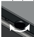
Obrázek č. 4. Vyrovnávání zařízení
