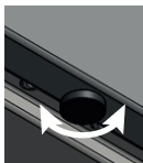
Obrázok 4. Vyrovnávanie zariadenia do vodorovnej polohy
