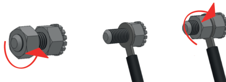
Bild 7. Der Anschluss des Gerätes an die Potentialausgleichsanlage
