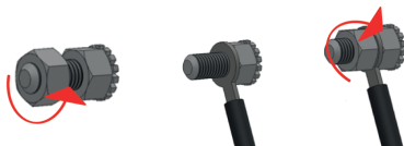
Figure 7. Connexion de l'appareil au dispositif équipotentiel.
