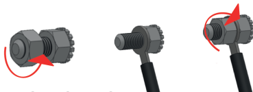
Obrázok 7. Pripojenie zariadenia k inštalácii na vyrovnávanie elektrických potenciálov.
