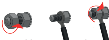
Figura 7. Conexión del equipo a una instalación equipotencial.
