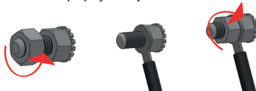
Obrázek 7. Připojení zařízení ke svorkovnici pro vyrovnání elektrických potenciálů.
