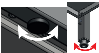
Obrázek č. 7. Vyrovnávání zařízení
