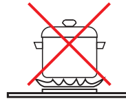
Der Boden ist für diesen Brenner zu klein
