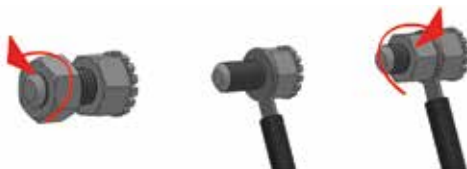
Bild 19. Der Anschluss des Gerätes an die Einrichtung zum Potentialausgleich.
